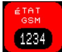
Elle indique les codes de fonctionnement du MODEM GSM (Uniquement pour le service technique).
