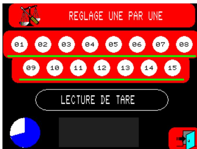
Une fois la lecture des tares achevée, une indication de **PLACER UN POIDS DE 1 Kg** apparaîtra sur l’écran. Il faudra alors placer un poids de 1 Kg dans chaque godet (un à chaque tour). Le carrousel s’arrêtera après le réglage du godet. Il faudra alors placer le poids dans le godet suivant et appuyer sur la touche MARCHE “ON”.
