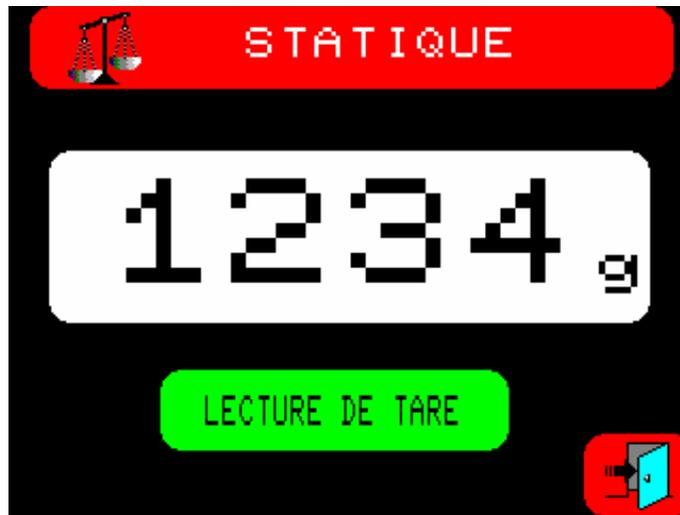
Il commence d'abord par la lecture des tares. **AUCUN POIDS NE DOIT ÊTRE PLACÉ DANS LES GODETS.**
